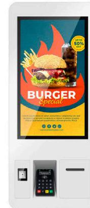
Impresora térmica integrada para recibos o tickets, de rollos de 80mm de ancho.
